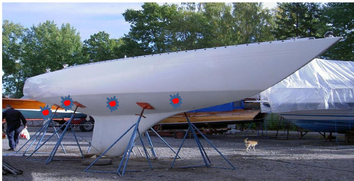
Figur 1. Mätpunkter på båtar mätta av Happy Boat AB. Mätningar utfördes 10-30 cm nedanför vattenlinjen på både styrbord och babord sida enligt bilden (styrbord bak, styrbord mitt, styrbord för, babord för, babord mitt och babord bak plus ömse sidor av rodret). På motorbåtar utan roder mättes på akterspeglar eller drevstocken.
